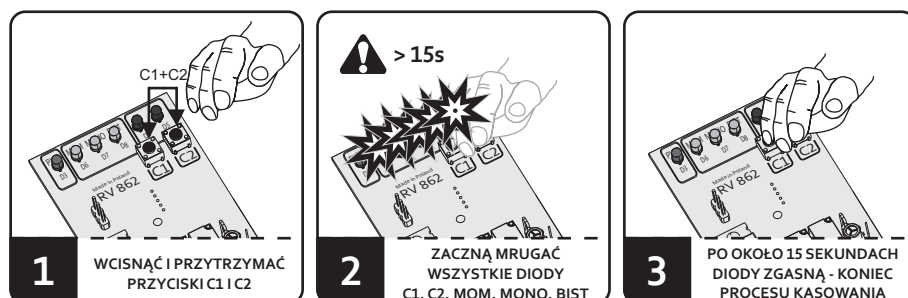
Rys. 9. Formatowanie pamięci odbiornika RIVAL862.
